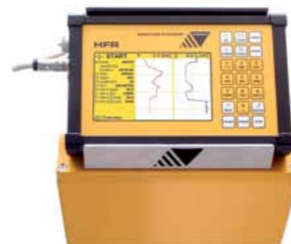
Фиг. 20. Уред HFR 006 за отчитане на налягането и дебита на 6 тръбопровода за разтвор Figure 20. HFR 006 Pressure and flow recorder for 6 grout lines.
