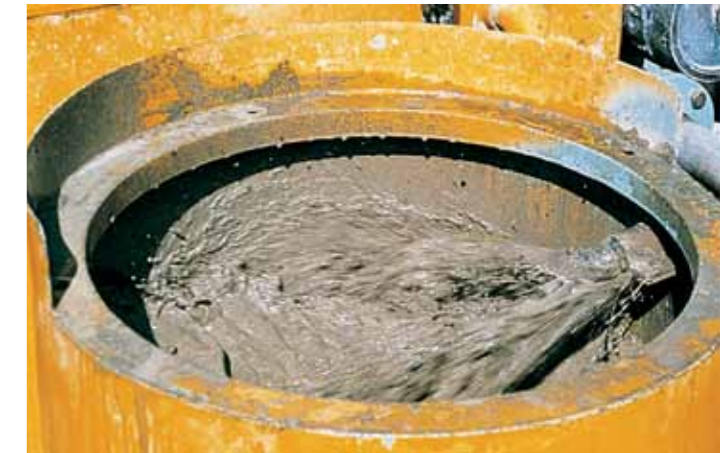
Фиг. 6. Миксер с големи срязващи сили и смесен поток на входа. Figure 6. High shear mixer with a mixed flow entrance.
