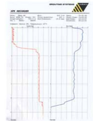
Фиг. 21. Разпечатване на отделните партиди инжектиране на разтвор Figure 21. Print-out of individual grouting sequences.
