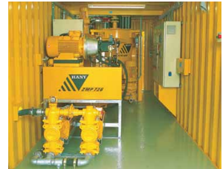
Инсталация MCM 2000/726 за помпане на големи разстояния към междуостровния тунел в Бостън, Масачузетс MCM 2000/726 plant for long distance pumping at the Inter-Island tunnel in Boston MA.
