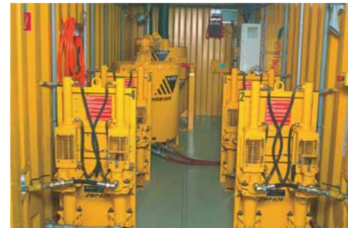
Фиг. 27. Напълно автоматизирана инсталация за строителен разтвор, поместена в ISO контейнер 20' с претегляне на партидата, 4 помпи и пълно отчитане Figure 27. Fully automated Grout Plant in 20' ISO Container with weigh-batching, 4 grout pumps and full monitoring.
