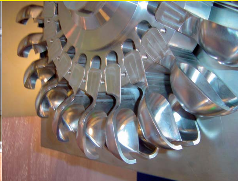
SCHAUFELRAD: Es kommt im neuen Kraftwerk zum Einsatz.
