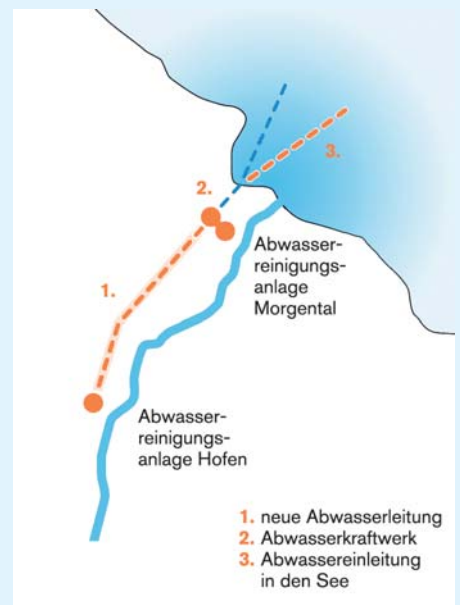
Die direkte Einleitung des gereinigten Abwassers aus der Kläranlage St. Gallen-Hofen in den Bodensee Bild 1
